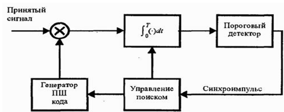
Рис. 3.1. Скользящий коррелятор для обнаружения синхроследовательности.
