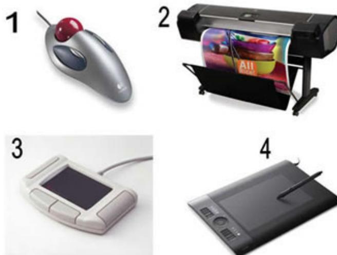
1) **Трекбол** — указательное устройство ввода информации об относительном перемещении для компьютера. Аналогично мыши по принципу действия и по функциям. Трекбол функционально представляет собой перевернутую механическую (шариковую) мышь.
