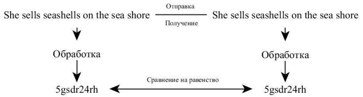
Рис. 2.4. Сравнение контрольных сумм строки до и после её передачи
