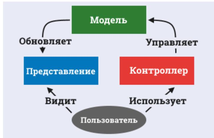
Рис. 2.1. Схема работы шаблона проектирования MVC
