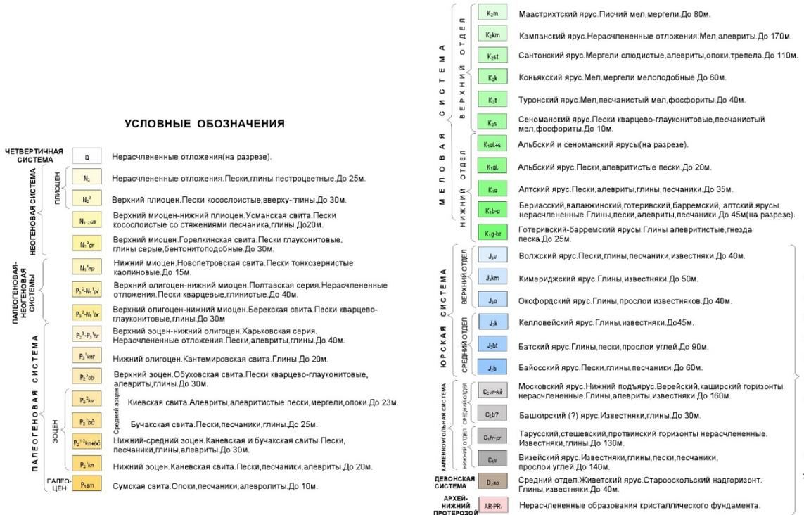
Рисунок 1.7 – Условные обозначения к геологической карте и разрезу
