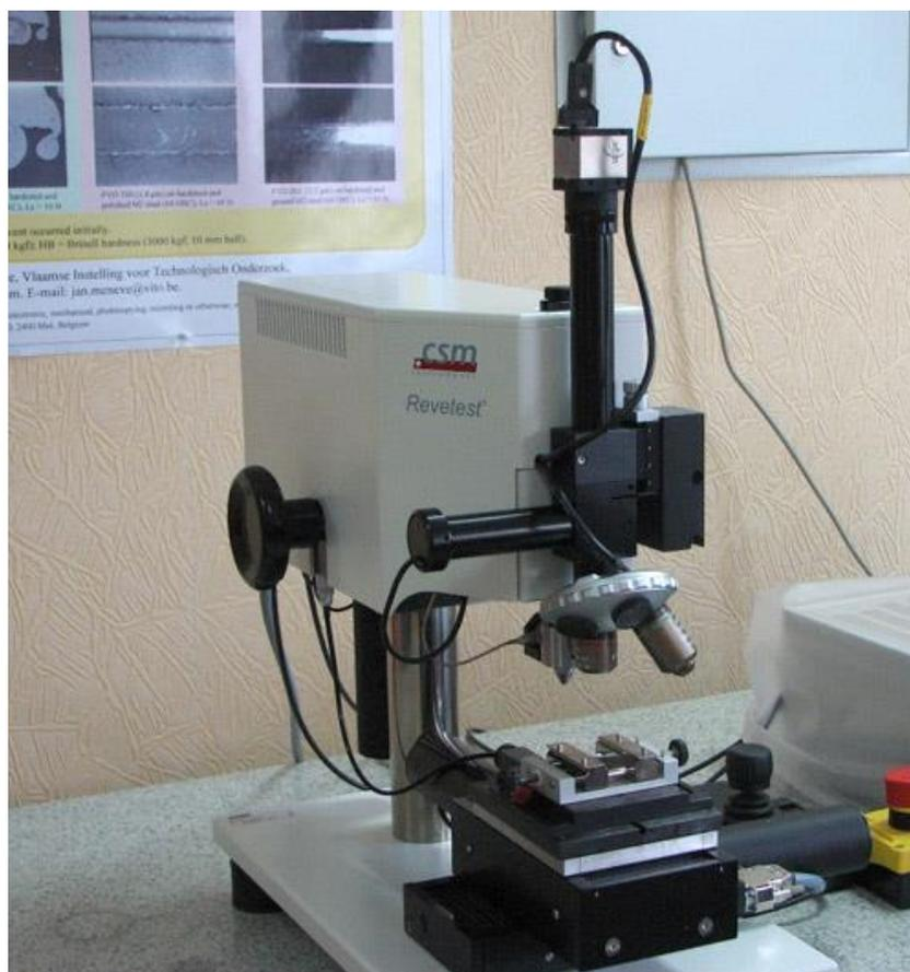
Рис. 2.2.8 Скретч-тестер REVETEST компании CSM Instruments
