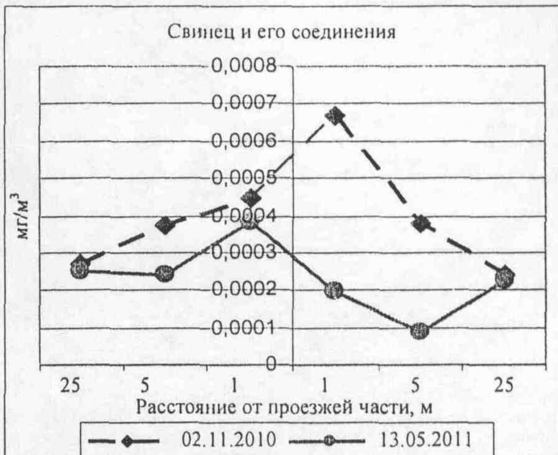
Рис. 3. Створы изменения концентраций оксида углерода, формальдегида, оксида азота (II), диоксида азота, пыли неорганической, свинца и его соединений на перекрестке ул. Костюкова–Михайловское шоссе–Волчанская (З–В) с южным ветром (вдоль оси ординат)
