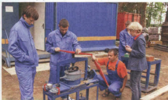
Студенты-геологи определяют прочность горных пород
