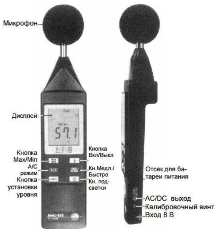
Рис.2.2. Устройство шумомера Testo 816
