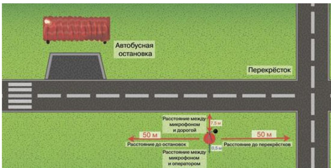
Рис. 2.1. Схема расположения оператора при проведении измерений
