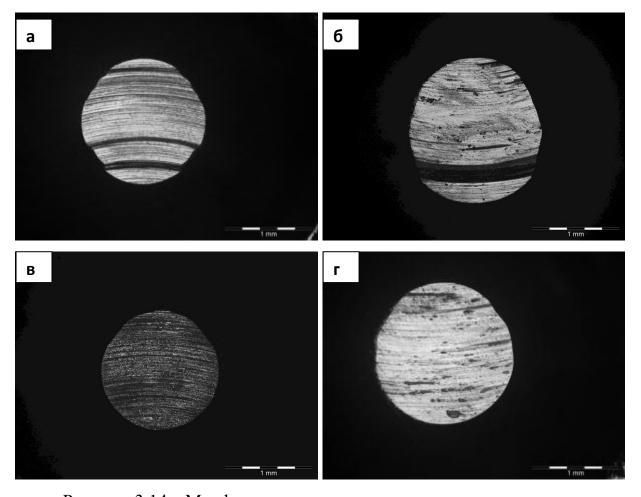
Рисунок 3.14 - Морфология поверхности пятна износа контртела после испытаний: а) TiN-Sn 50%-50% (80 мм); б) TiN-Sn 70%-30% (80 мм); в) TiN-Sn 50%-50% (160 мм); г) TiN-Sn 70%-30% (160 мм)
