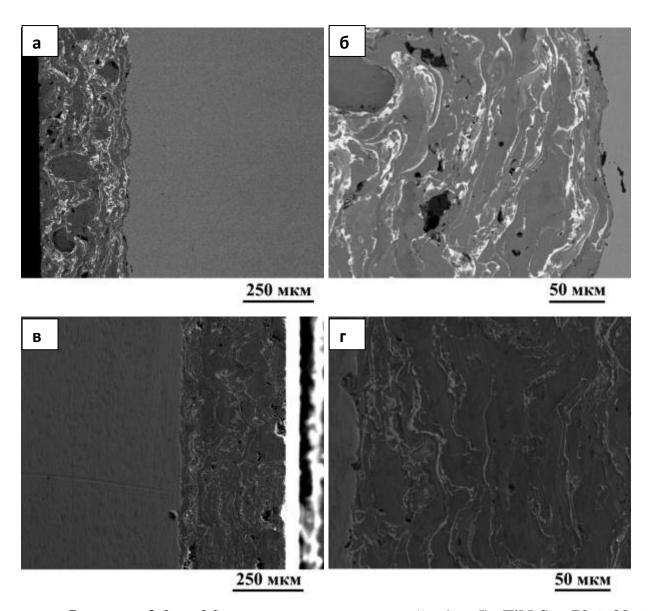
Рисунок 3.3 - Микроструктура покрытий: (а, б) TiN-Sn 70%-30% (80мм); (в, г) TiN-Sn 70%-30% (160 мм)
