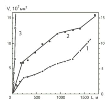
Рисунок 1.4. - Зависимость изменения объемного износа V от длины перемещения контртела L для образцов с покрытием из TiN, нанесенного в режиме ионно-плазменной имплантации (кривая 1), в режиме непрерывного осаждения (кривая 2), а также для образцов с покрытием (кривая 3) [8]
