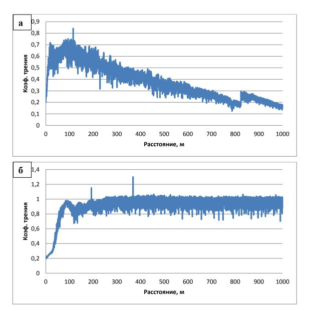
Рисунок 3.11 - Зависимость коэффициента трения от времени испытания: a) TiN-Sn 50%-50% (80 мм); б) TiN-Sn 70%-30% (80 мм)
