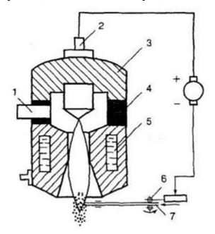
Рисунок 1.5. - Принципиальная схема плазменного напыления с применением проволоки: 1 - подвод плазмообразующего газа, 2 - катод плазмотрона, 3 - корпус катода, 4 - изолятор, 5 – корпус анода, 6 – механизм подачи проволоки, 7 – сплошная или порошковая проволока, 8 - плазменная дуга, 9 - источник питания
