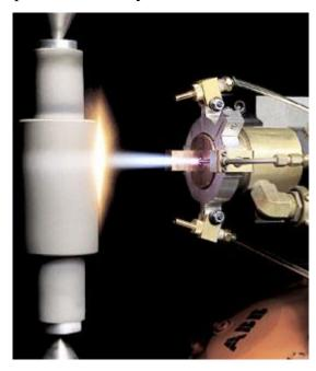
Рисунок 1.2. – Внешний вид процесса газотермического напыления
