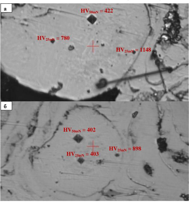
Рисунок 3.10. - Восстановленные отпечатки после измерения твердости методом наноиндентирования: а) TiN-Sn 50%-50% (80мм); б) TiN-Sn 70%-30% (80мм)
