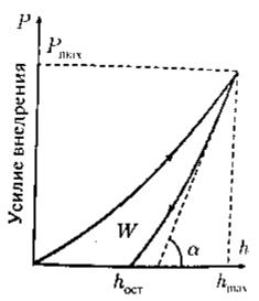
Рисунок 2.3 - Диаграмма, полученная при наноиндентировании:  $h_{max}$  - максимальная глубина погружения индентора;  $h_{ocm}$  - глубина отпечатка, оставшегося после снятия нагрузки; W – поглощённая энергия
