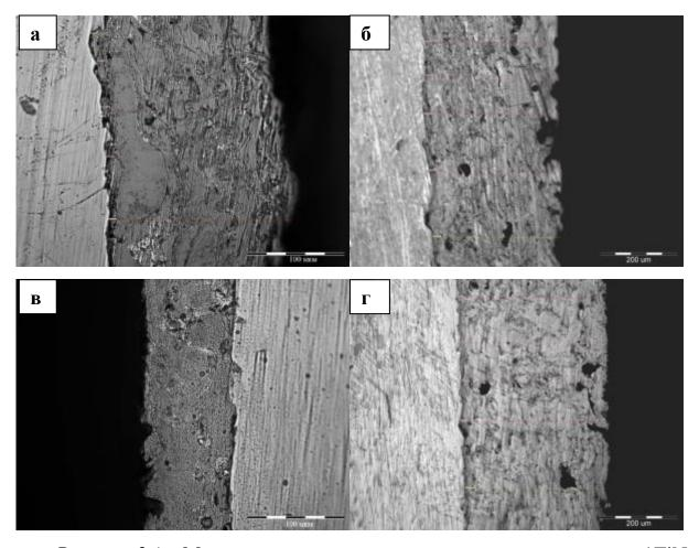
Рисунок 3.1 - Микроструктура покрытия в поперечном сечении: a)TiN-Sn 50%-50% (80 мм); б) TiN-Sn 70%-30% (80 мм); в) TiN-Sn 50%-50% (160мм); г) TiN-Sn 70%-30% (160 мм)
