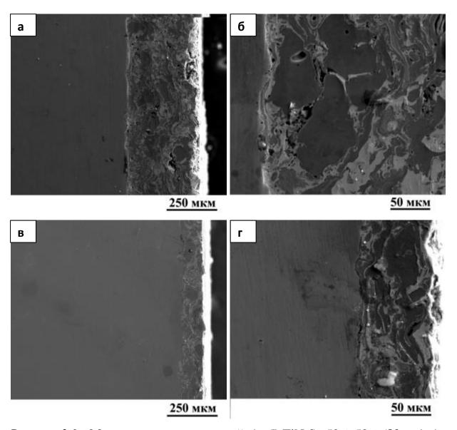
Рисунок 3.2 - Микроструктура покрытий: (а, б) TiN-Sn 50%-50% (80 мм); (в, г) TiN-Sn 50%-50% (160 мм)
