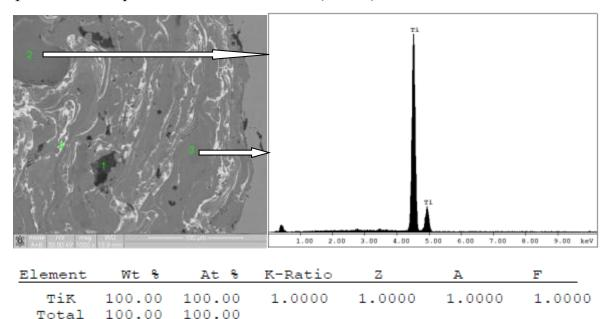
Рисунок 3.5 - Микроструктура и элементный состав частиц в покрытии TiN-Sn 70%-30% (80 мм)
