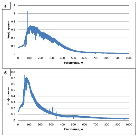
Рисунок 3.12 - Зависимость коэффициента трения от времени испытания: a) TiN-Sn 50%-50% (160 мм); б) TiN-Sn 70%-30% (160 мм)
