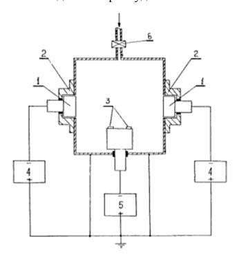
Рисунок 1.1. – Принципиальная схема установки типа «Булат» для осаждения покрытий: 1 – расходуемый электрод (катод), 2 – не расходуемый электрод (анод), 3 – подложка (образцы), 4 – источник питания дуги испарителей, 5 – источник смещения потенциала подложки, 6 – клапаннатекатель подачи реактивного газа (азота) [6]
