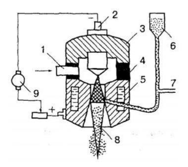
Рисунок 1.4. - Принципиальная схема плазменного порошкового напыления: 1 - подвод плазмообразующего газа, 2 - катод плазмотрона, 3 - корпус катода, 4 - изолятор, 5 - корпус анода, 6 -порошковый питатель, 7 - подвод газа-носителя порошка, 8 - плазменная дуга, 9 - источник питания
