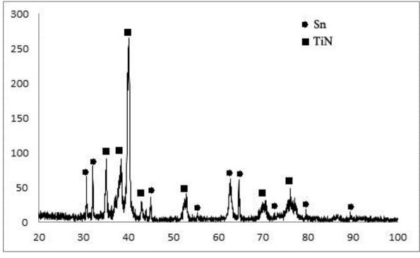
Рисунок 3.7 - Рентгенограмма покрытия TiN-Sn 70%-30% (80 мм)
