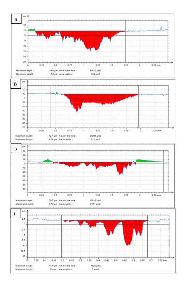
Рисунок 3.15 — Типичный вид профилограммы поперечного сечения дорожки износа: a) Ti-Sn 50%-50%(80 мм); б) Ti-Sn 70%-30%(80 мм); в) Ti-Sn 50%-50%(160 мм); г) Ti-Sn 70%-30%(160 мм)
