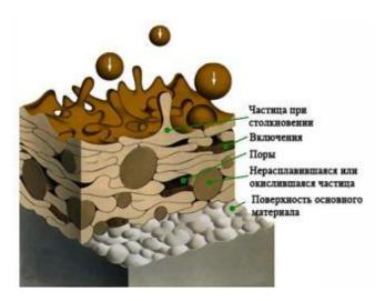
Рисунок 1.6. – Схематического представление структуры покрытия, формирующейся в процессе обработки
