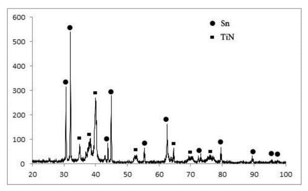
Рисунок 3.8 - Рентгенограмма покрытия TiN-Sn 50%-50% (160мм)
