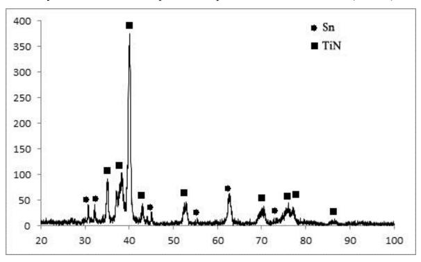
Рисунок 3.9 - Рентгенограмма покрытия ТіN-Sn 70%-30% (160 мм)
