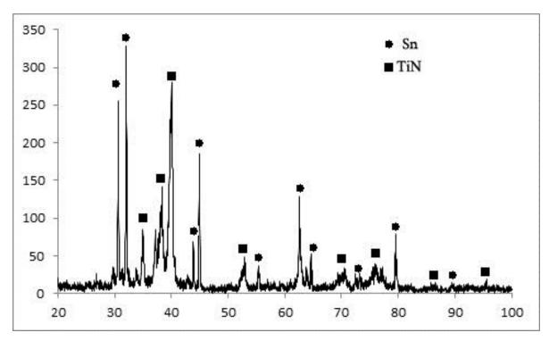
Рисунок 3.6 - Рентгенограмма покрытия TiN-Sn 50%-50% (80 мм)
