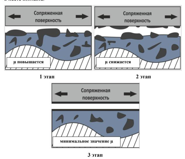
Рисунок 3.13 - Механизм формирования антифрикционных пленок в процессе трения композиционных покрытий, содержащих в своем составе смазку
