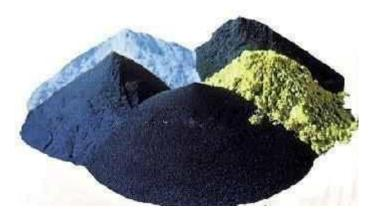
Рисунок 1.3. Порошки для напыления
