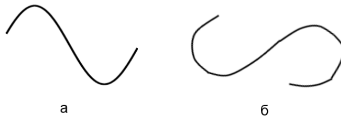
Рис. 11. Форма скелетной линии змееподобного робота. а – форма скелета когда предельный угол отклонения звена составляет значения меньше \theta_{0max} , б – форма скелета при значениях равных \theta_{0max} .
