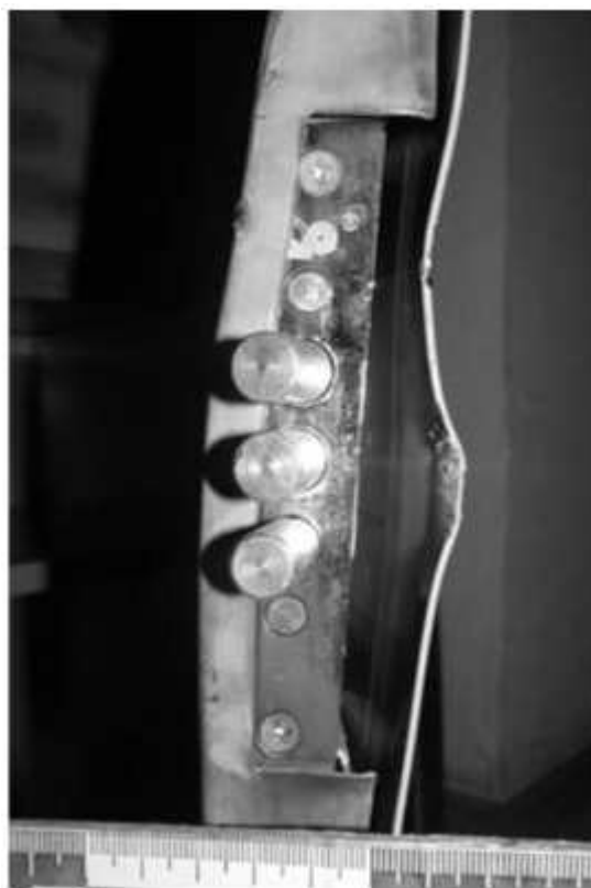
Фото 3. Вид деформации дверцы и головок ригеля замка.
