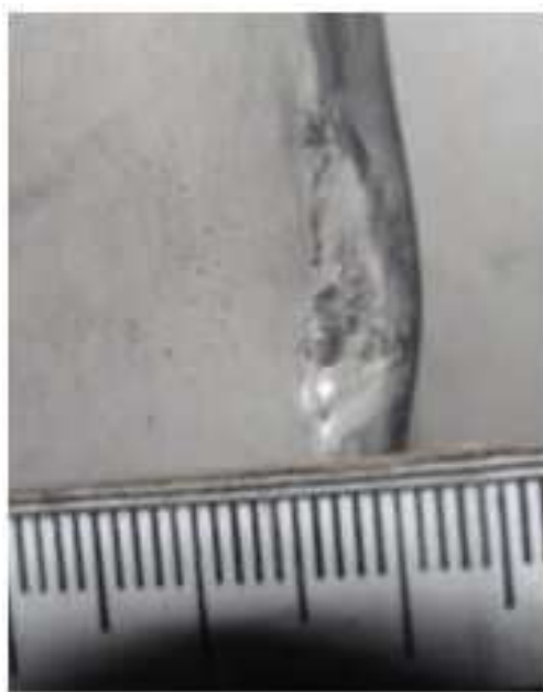
Фото 4. Вид следа давления на внутренней поверхности дверцы.
