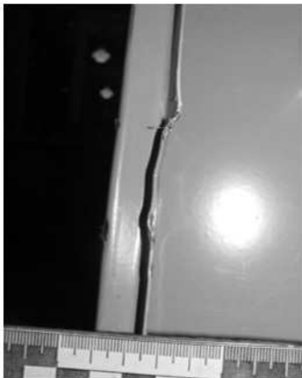
Фото 5. Вид деформации планки, служащей для упора головок ригеля.
