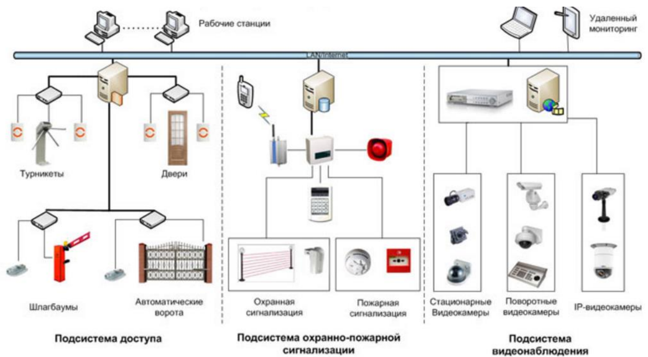
Рисунок 4.2 – Общая структура сети охранных систем в Яковлевской ЦРБ
