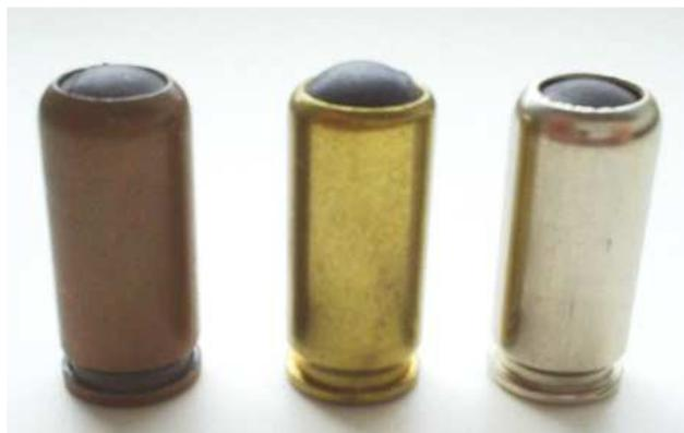
Рис.1.1. 1- биметаллическая, 2- латунная, 3- стальная
