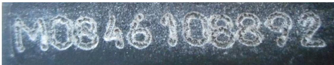
Фото 4. На рамке под обоймой расположено маркировочное обозначение, на пистолете №М0846108892, представленном на исследование.
