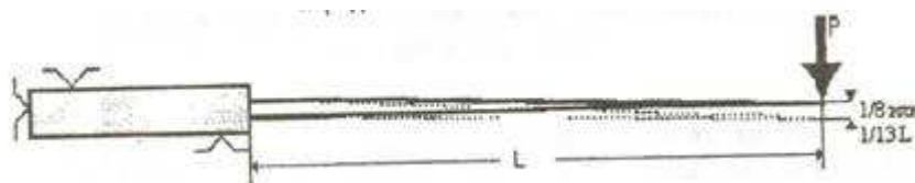
Рис. 3.3. Схема проведения испытаний на прочность и упругость сабель и шашек, предназначенных для ношения с казачьей формой и национальными костюмами РФ
