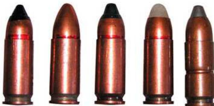
Рис. 2.5. Пистолетные патроны 9х21 (слева – направо): СП–10 – с бронебойной пулей со стальным термоупрочненным сердечником; СП–11 – с пулей со свинцовым сердечником в биметаллической оболочке; СП–12 – с пулей со стальным сердечником; образцовый; учебный<sup>1</sup>
