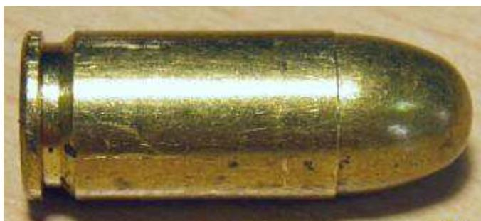
Рис 2.4. Пистолетный патрон 9x17мм Курц<sup>1</sup>
