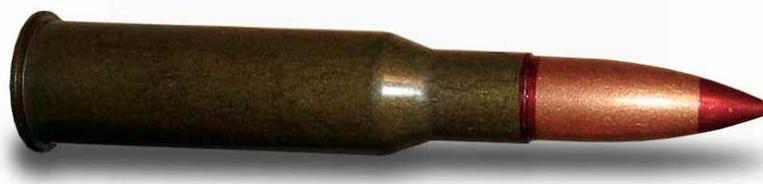
Рис. 2.12. Винтовочно–пулеметный патрон 7,62–мм с тяжелой пулей<sup>2</sup>
