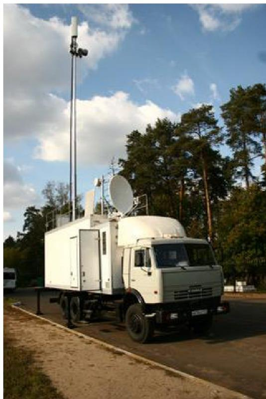
**Рисунок 1.7 – Мобильный вариант базовой станций**
