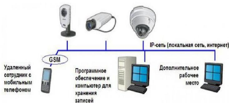
**Рисунок 2.2- Типовая структура системы IP-видеонаблюдения**
