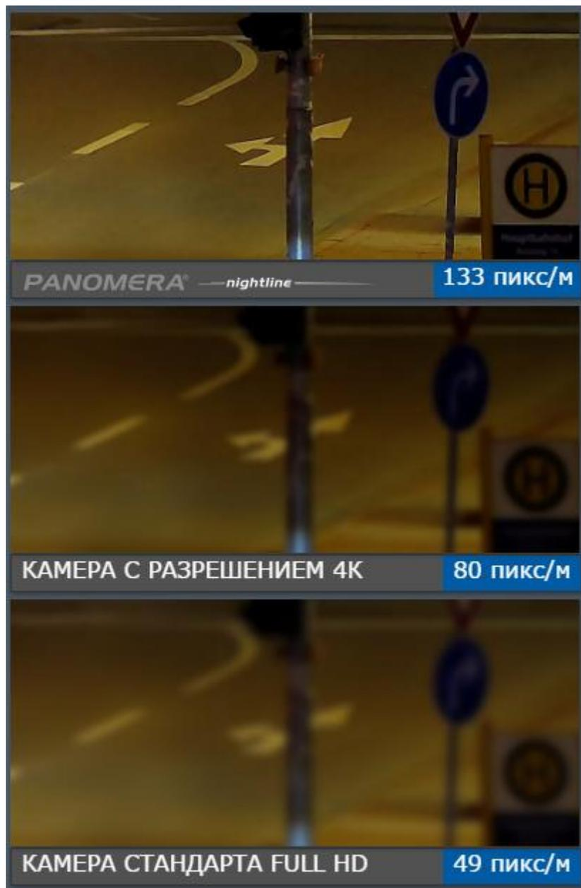
Рисунок 2.6 – Сравнение «Panomera» с другими камерами (Расстояние – 97 метров, ночь)
