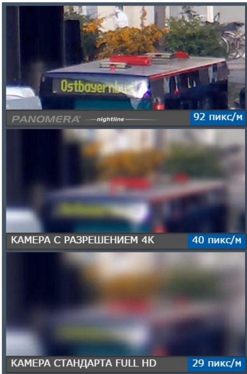
Рисунок 2.7 – Сравнение «Panomera» с другими камерами (Расстояние – 217 метров, день)
