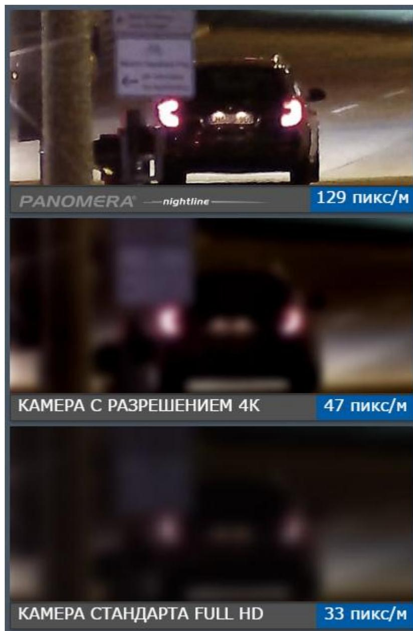
**Рисунок 2.8 – Сравнение «Panomera» с другими камерами (Расстояние – 200 метров, ночь)**
