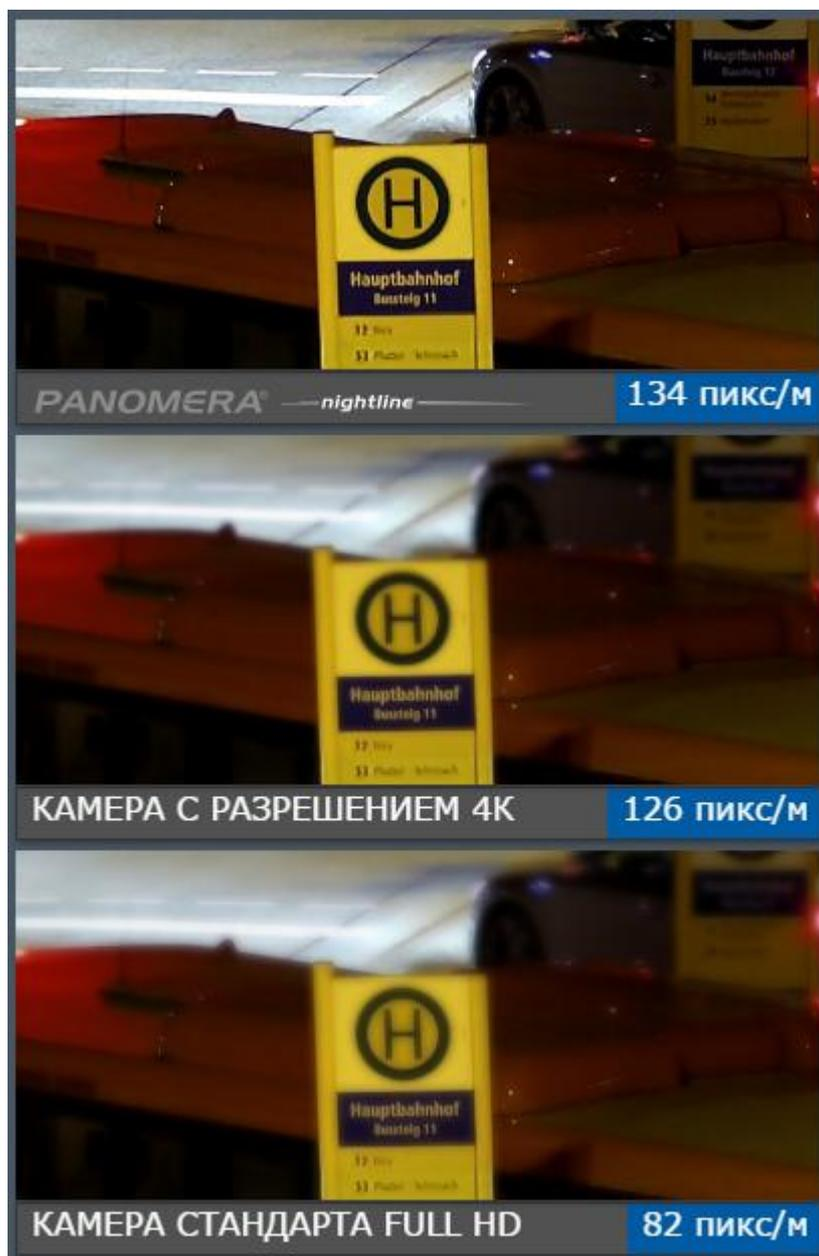
Рисунок 2.4 – Сравнение «Panomera» с другими камерами (Расстояние – 47 метров, ночь)
