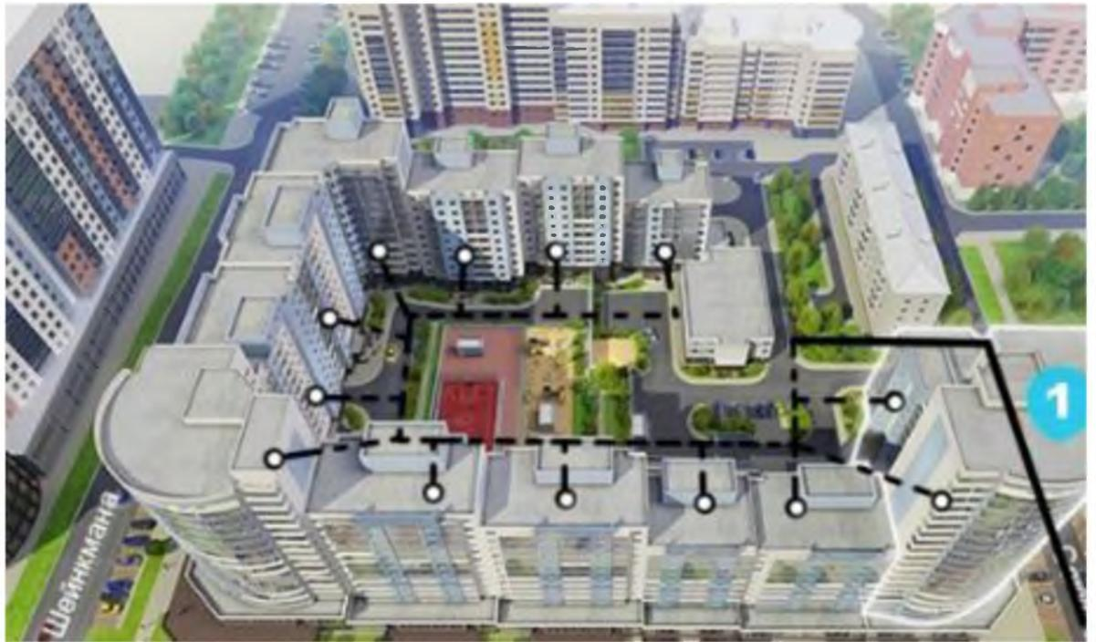
**Рисунок 4.2 – Схема прокладки оптоволокну в ЖК «Мечта»**
