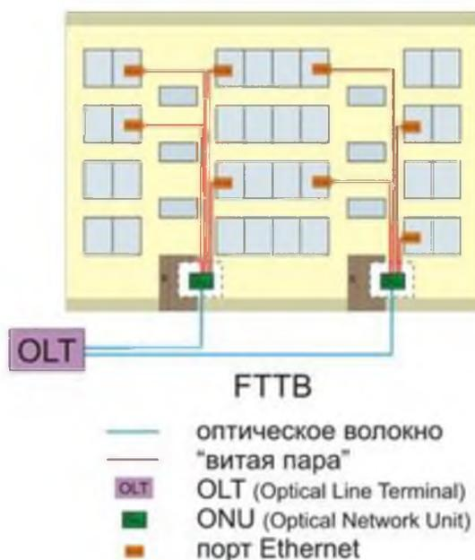
**Рисунок 2.5 – Типовая схема реализации технологии FTTH**
