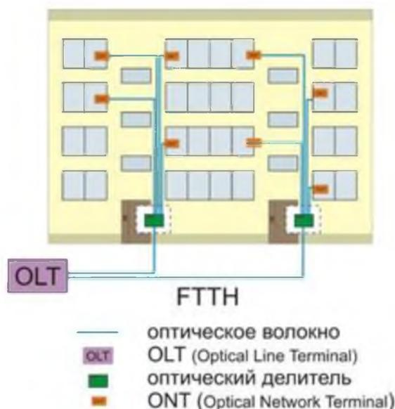
**Рисунок 2.6 – Типовая схема реализации архитектуры FTTH**
