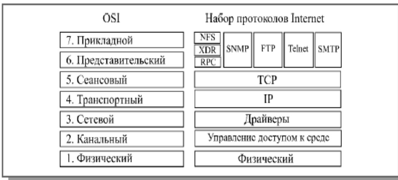
Рисунок 2.5 - Соотношение уровней модели OSI и используемых протоколов
