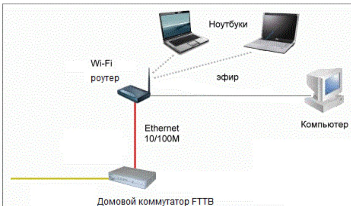
Рисунок 3.6 – Схема подключения с использованием маршрутизатора.
