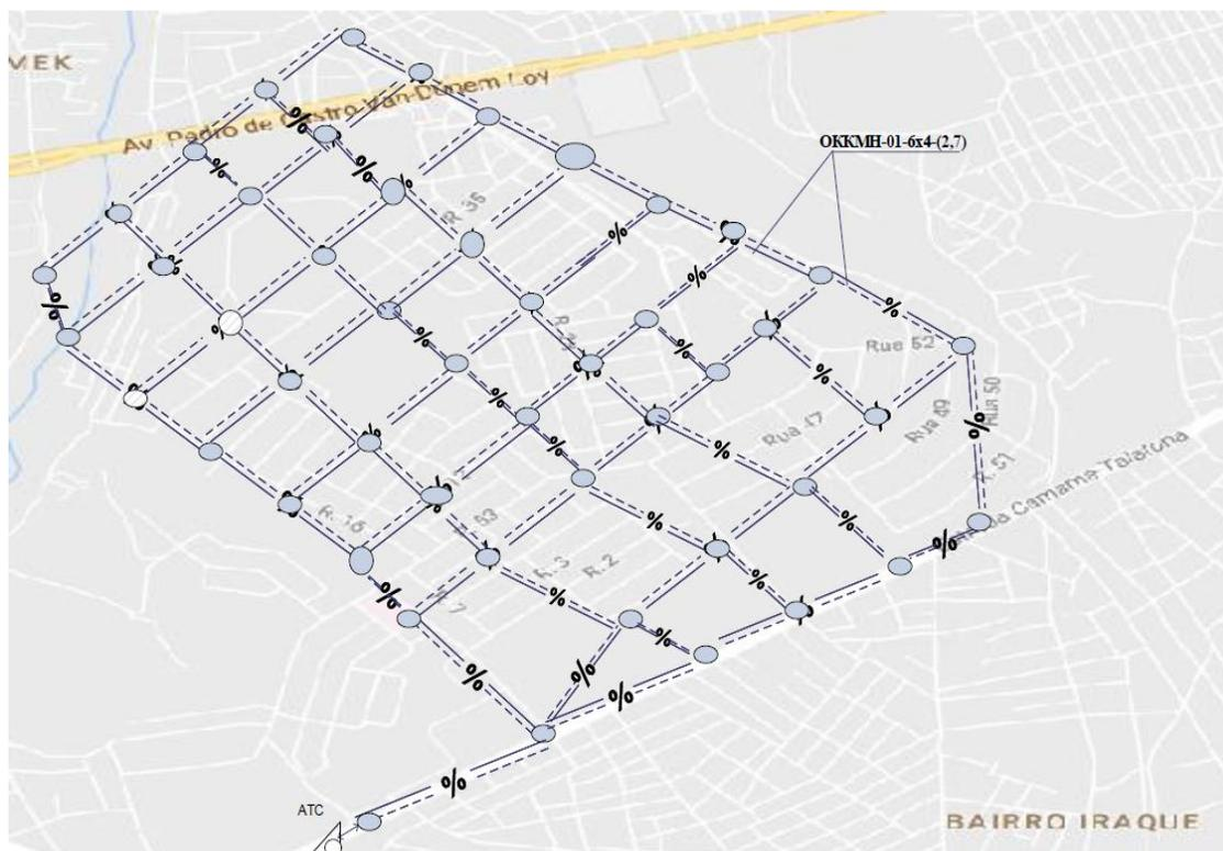
**Рисунок 6.2 – Проектируемая схема прокладки кабеля в телефонной кабельной канализации**
