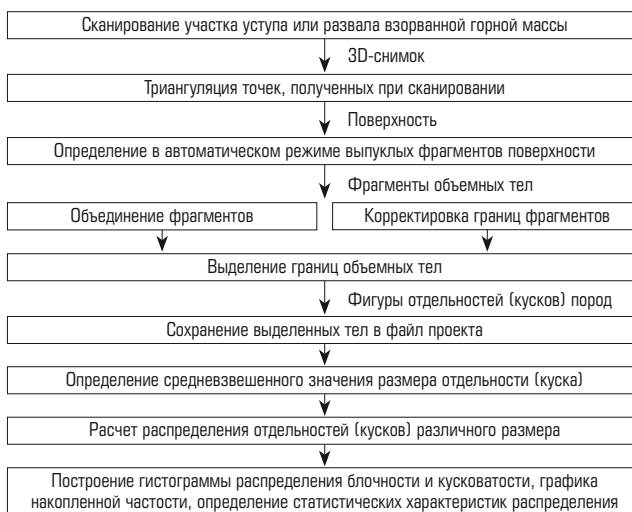
Рис. 4. Блок-схема алгоритма оценки блочности пород в уступах карьера и кусковатости взорванной горной массы с использованием системы лазерного сканирования
