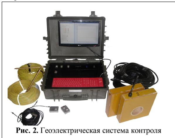
Рис. 2. Геоэлектрическая система контроля
