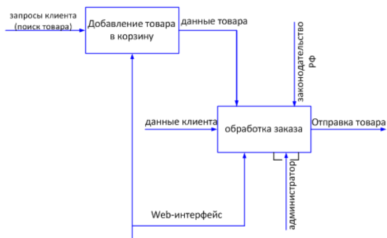
Рис. 1.2. Второй уровень функциональной модели
