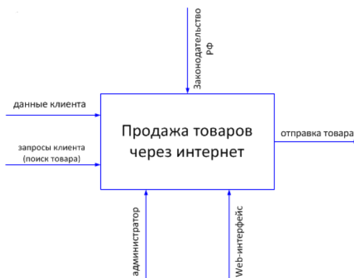
Рис. 1.1. Контекстная диаграмма функциональной модели
