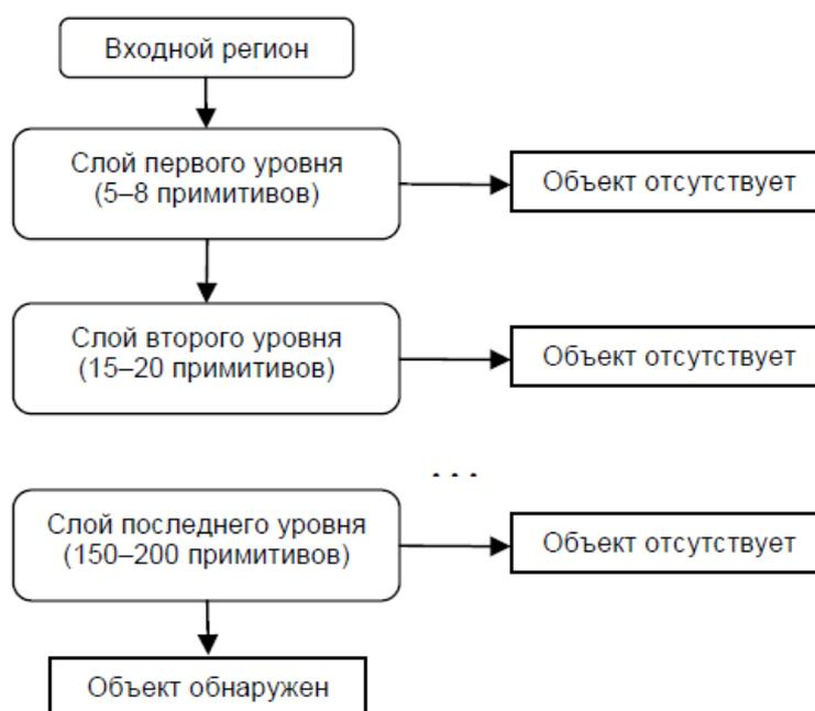
Рисунок 2.4 – Пример каскадной модели сильных классификаторов
