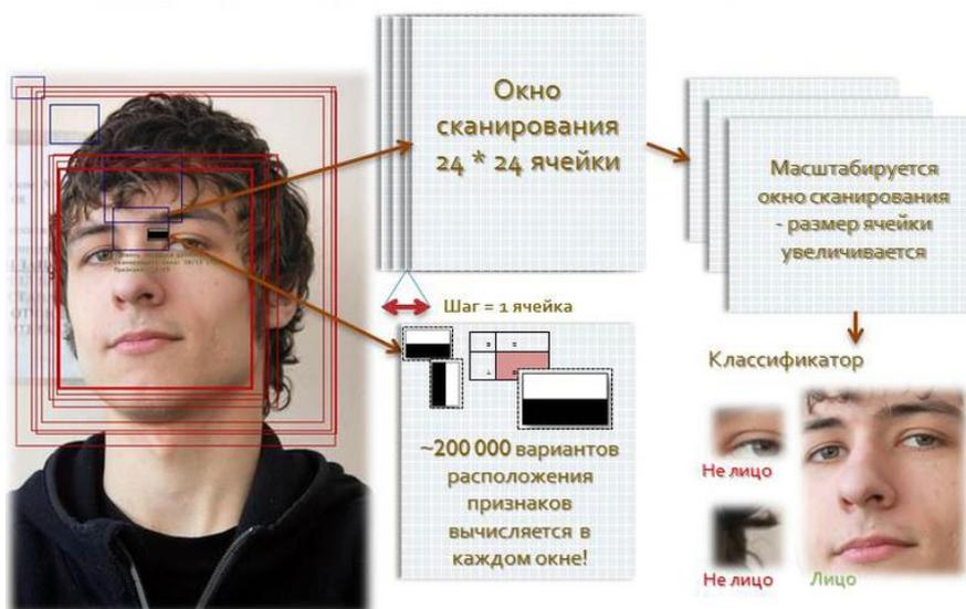
Рисунок 2.2 - Визуализация алгоритма сканирующего окна
