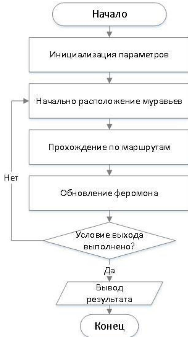
Рис. 2.2.3 Блок-схема метода муравьиной колонии
