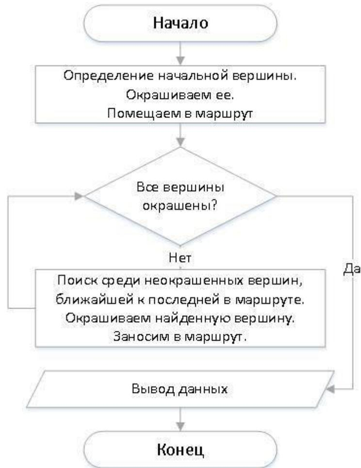
Рис. 2.2.1 Блок-схема алгоритма ближайшего соседа
