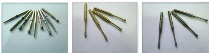
Рисунок 6. Алмазные боры «РосБел»: а) без покрытия; б) с нитрид-титановым покрытием (TiN); в) покрытие двойным нитридом (TiAl)N.
