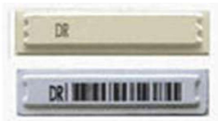
Рис. 10. Внешний вид акустомагнитной метки. Этикетка LE, Размер: 10×44 мм; рабочая частота: 58 КГц; вид: белые, с ложным штрих-кодом; 2 контура
