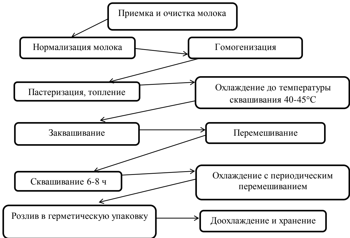
Рис. 2.4. Процесс производства ряженки резервуарным способом.
