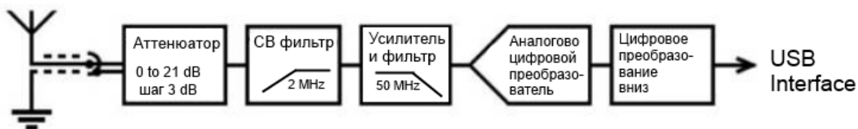
Рисунок 1.8 – Структурная схема DDC приемника
