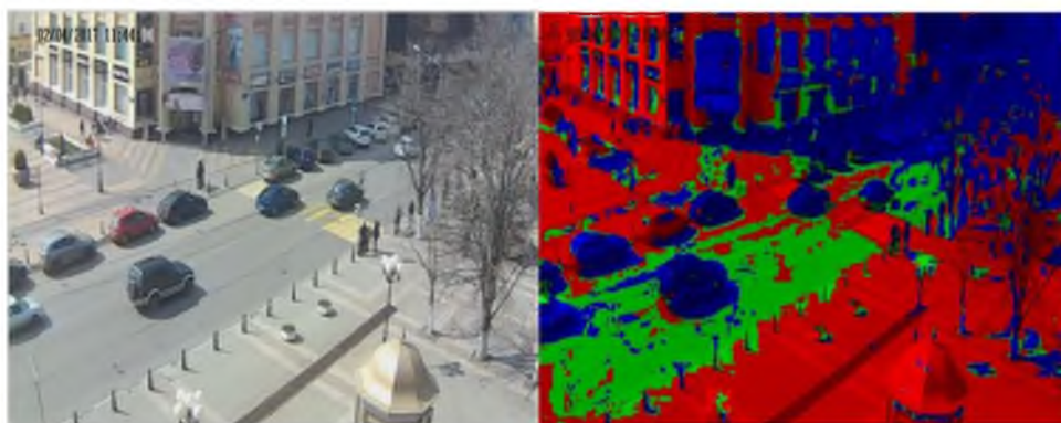
Рисунок 1 – Пример работы фильтра предварительной обработки перед сегментацией кадра
