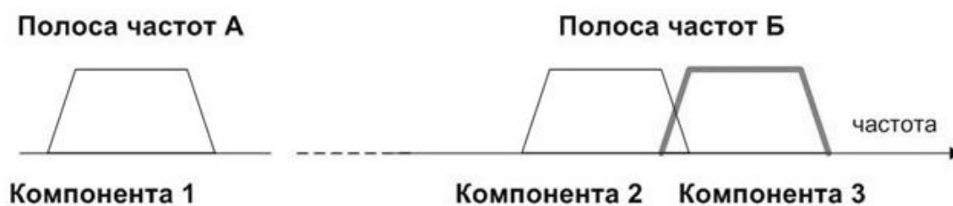
Рисунок 2.2 - Агрегирование компонентных несущих LTE-Advanced из разных полос частот
