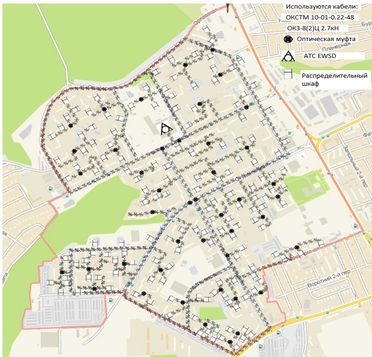
Рисунок 5.2– схема прокладки кабеля в микрорайоне Северо-Западный г. Курск
