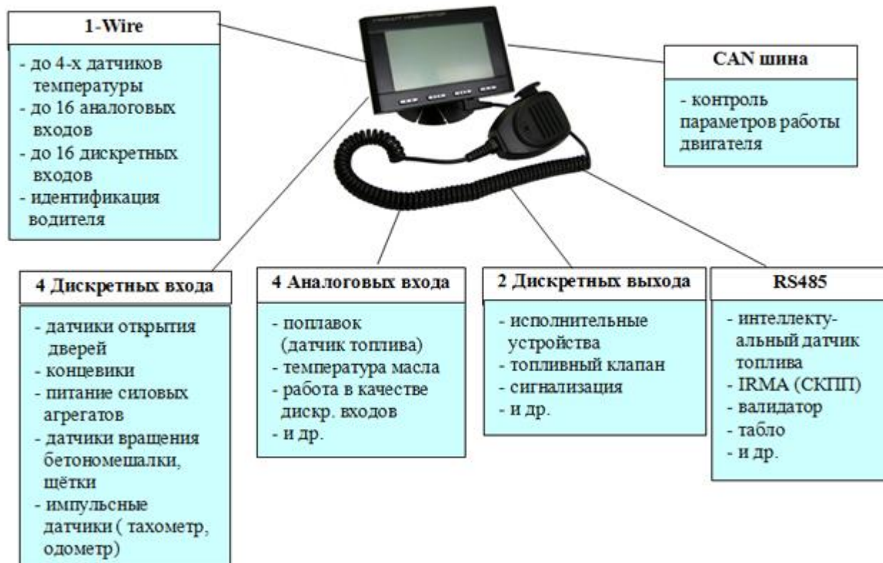
Рисунок 4.1 – схема подключения Навигатора 2.07 к оборудованию транспортного средства
