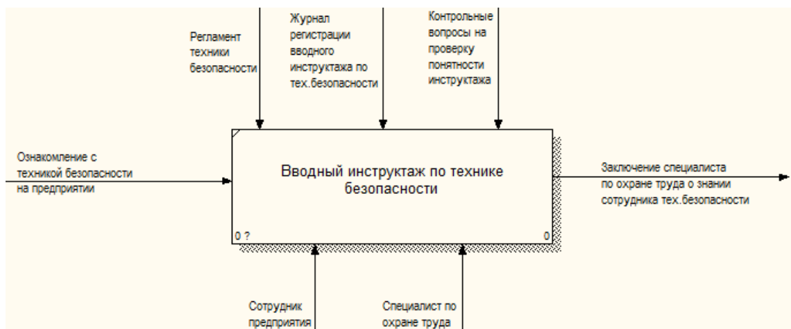
Рисунок 3.3 – Диаграмма IDEF0 процесса «Вводный инструктаж по технике безопасности»
