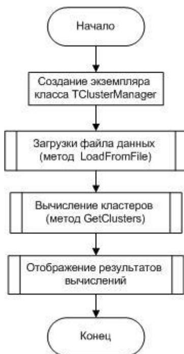
Рисунок 2.1 Базовая последовательность действий программы
