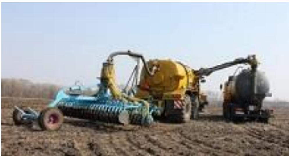
*Рис. 2.2.*Внесение органического удобрения на поля Террагатором
