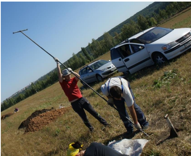
Рис.2.3. Бурение скважины глубиной 5 м
