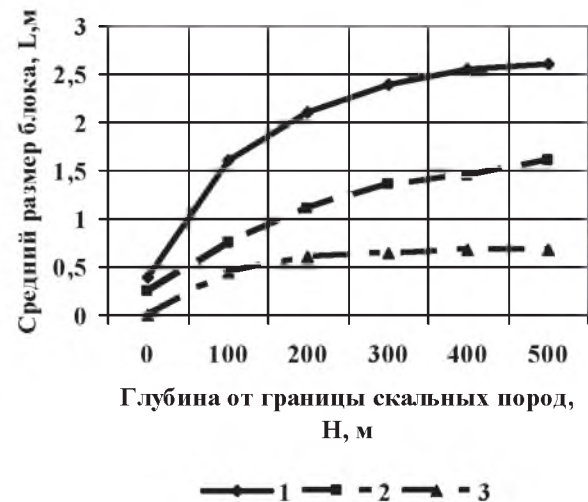
Рис. 1. Изменения блочности горного массива железорудных месторождений при углублении карьеров. 1 – магматические Ковдорское, Качканарское; 2 – контактово-метасоматические и гидротермальные (Сарбайское, Соколовское, Гороблагодатское, Высокогорское; 3 – метаморфогенные (Оленегорское, Криворожское, КМА руда)
