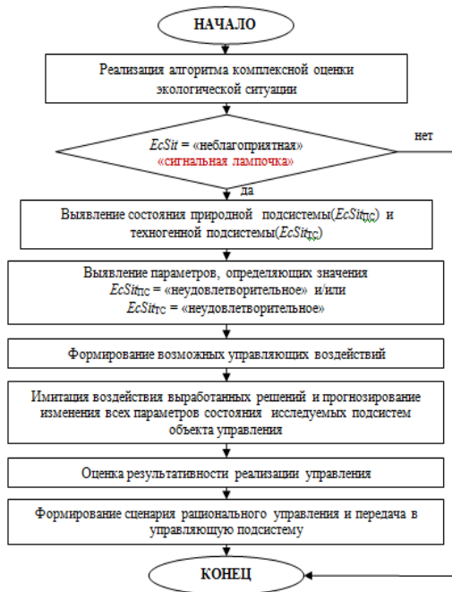
Рисунок 5 – Алгоритм формирования сценариев управления биотехносферой локальных урбанизированных территорий, обеспечивающих регуляризацию экологической ситуации
