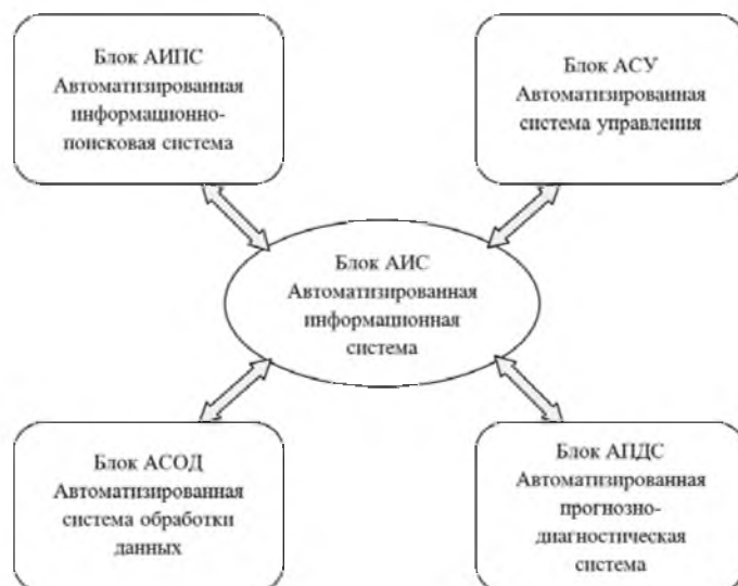
Рис. 2. Схема структуры автоматизированной информационной системы мониторинга геодинамических процессов
