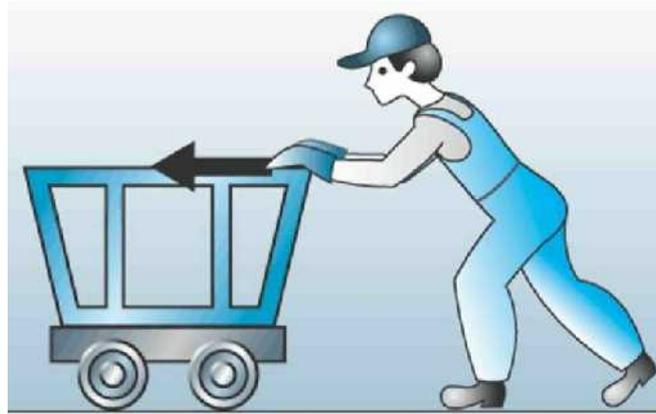
Рис. 4.1 На примере силового воздействия рабочего на тележку стрелкой условно обозначены абсолютное значение, направление и точка приложения силы (другие силы не показаны)
