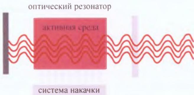
Рис. 5. Схема работы оптического квантового генератора
