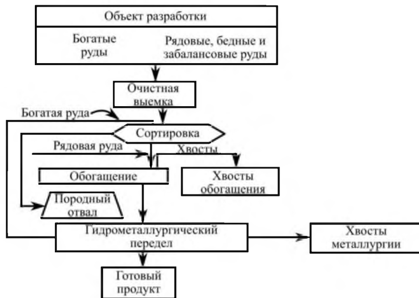
Рис.3. Схема добычи и переработки руд
